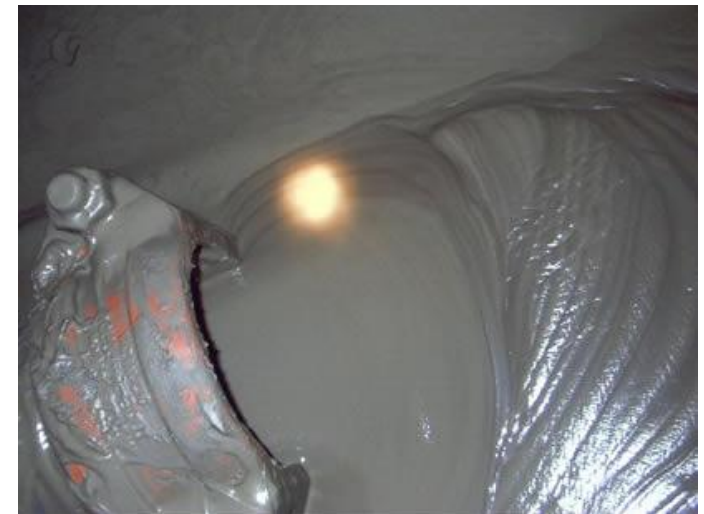
Relleno hidráulico que se vierte en un tajo abierto.
